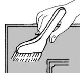
1回目の塗装後8時間以上（できれば一夜以上おく）乾燥させ、軽く研磨してから、1回目と同じ方法で塗装して仕上げます。
